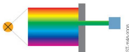
Nur der grüne Anteil des eingestrahnten Lichts wird herausgefiltert und dessen Intensität gemessen.
