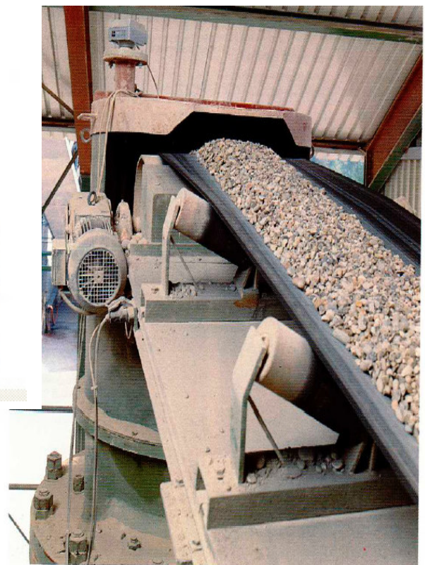
Mengensteuerung für einen Brecher durch eine Ultraschall-Meßeinrichtung
