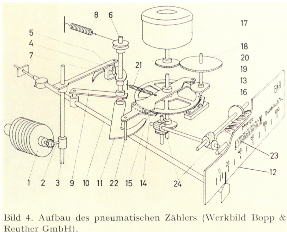
Bild 4. Aufbau des pneumatischen Zählers (Werkbild Bopp & Reuther GmbH).
