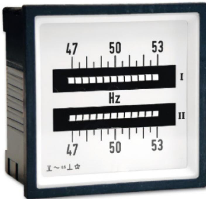
Das Vibrations-Messwerk dient zur Frequenzbestimmung des Wechselstromes. Eine Anzahl Stahlzungen ist auf bestimmte Eigenschwingungszahlen abgestimmt und in einer Reihe im Kraftfeld einer langgestreckten Spule angeordnet. Fließt Wechselstrom durch die Wicklung, so wird durch das Wechselfeld diejenige Zunge in Schwingung versetzt, deren Eigenschwingungszahl gleich der Polwechselzahl, das heißt der doppelten Frequenz des Wechselstromes ist.
