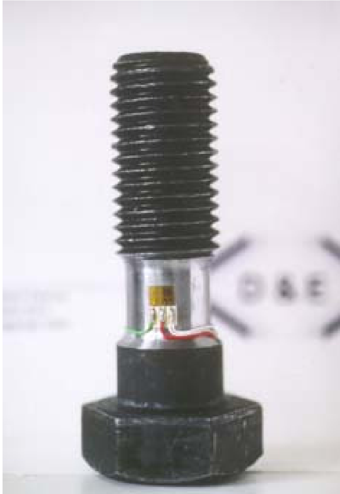
Zugkraftmessung in einer Maschinenschraube
