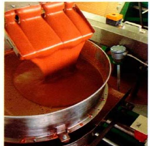
Kapazitive Füllstandmeßeinrichtung zur Niveau-Konstanthaltung an einer Nougat-Gießmaschine in einer Schokoladenfabrik
